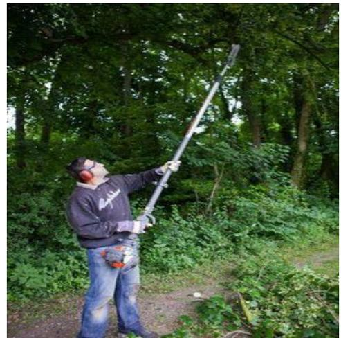
Attention au sens du sécateur, Sa lame coupante doit être placée du côté de l'arbre, car la partie d'appuis **abime l'écorce**
